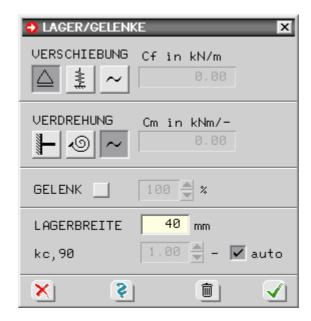
Die Wahl der Lagerbedingung für Verschiebung und Verdrehung erfolgt über die Optionsschalter. Bei elastischer Lagerung wird das entsprechende Eingabefeld für die Federsteifigkeit freigeschaltet.
