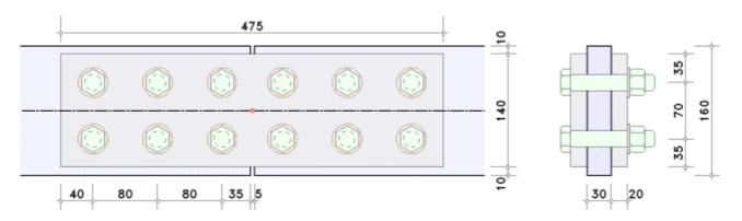
Zwei Bleche gleicher Abmessungen werden mittels geschraubter Laschen verbunden.
