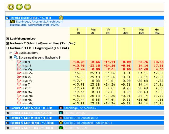
In 4H-EC3SA ist der komplette verfügbare Schnittgrößensatz importierbar, was durch gelbe Hinterlegung der Spalten angezeigt wird.
