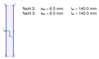
Bezogen auf den Schwerpunkt des Linienquerschnitts werden die Querschnittsfläche  $\Sigma A_w$ , ggf. die Querschnittsflächen in y- und z-Richtung  $A_{w,y}$ ,  $A_{w,z}$ , die gesamte Nahtlänge  $\Sigma I_w$ , die Trägheitsmomente  $I_{w,y}$ ,  $I_{w,z}$ ,  $I_{w,z}$ , und die Differenzabstände zum Querschnittsschwerpunkt  $\Delta y_w$ ,  $\Delta z_w$  ermittelt.
