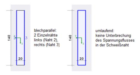
Ein Blech wird mit Kehlnähten senkrecht auf eine Platte geschweißt.
