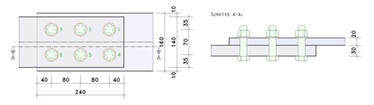
Zwei Bleche werden mittels Schrauben verbunden. Das Schraubenbild ist bzgl. der Systemachse symmetrisch.
