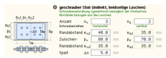
Eine Prinzipskizze zeigt die Bedeutung der abgefragten Parameter; die x-Richtung entspricht der (horizontalen) Beanspruchungsrichtung; in (vertikaler) z-Richtung wird an den Blechen ein freier Rand angenommen.
