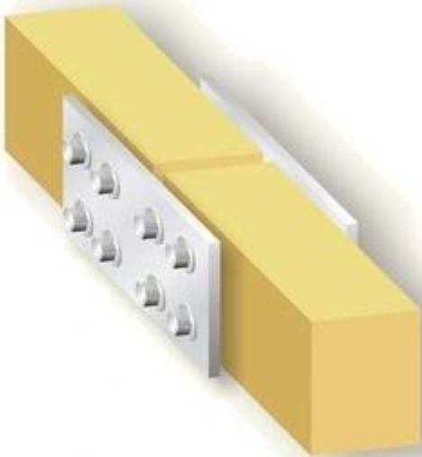
Stoß mit außen liegenden Stahlblechen
