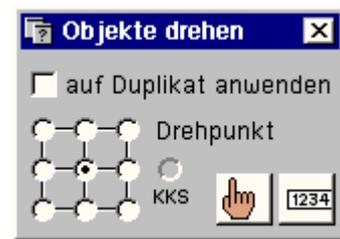
Im 3D-Modus findet die Drehung um eine Achse statt, die durch den hinführenden Vektor  $[x_0, y_0, z_0]$  und den eigentlichen Achsvektor  $[a_x, a_y, a_z]$  definiert wird (s. Skizze im Eigenschaftsblatt). Der Drehwinkel  $\alpha$  ist ebenfalls vorzugeben.
