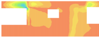
Ausnutzung U_{\sigma yy} min U_{\sigma yy} = 0.000 , max U_{\sigma yy} = 0.244
