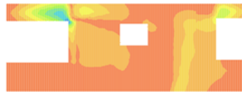
Ausnutzung U_{\sigma yy} min U_{\sigma yy} = 0.000 , max U_{\sigma yy} = 0.244
