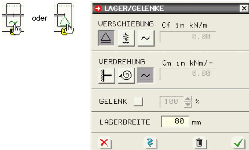
Die Wahl der Lagerbedingung für Verschiebung und Verdrehung erfolgt über die Optionsschalter. Bei elastischer Lagerung wird das entsprechende Eingabefeld für die Federsteifigkeit freigeschaltet.
