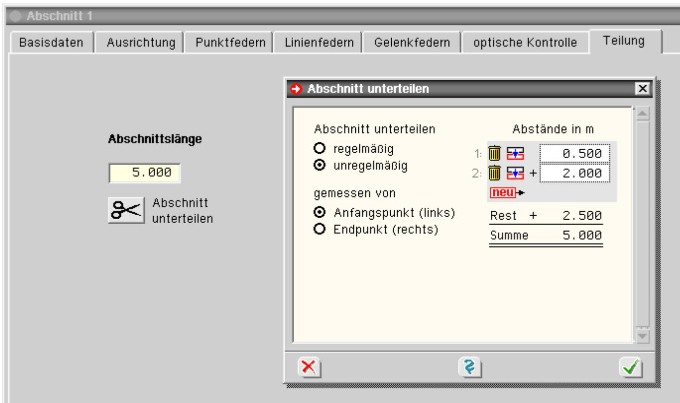
Neben der Änderung der Abschnittslänge im hierfür angebotenen Eingabefeld besteht die Möglichkeit, den Trägerabschnitt über das **Scherensymbol** zu unterteilen.
