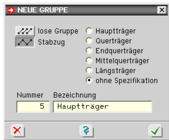
diese zu einer Stabgruppe zusammengefasst werden, indem der Button zur Gruppendifinition angeklickt wird (Ausnahmen s.u.).
