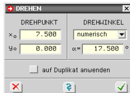
Die Rotation kann an einem Duplikat der aktuell ausgewählten Objekte durchgeführt werden. Die gedrehten Objekte werden dem unverändert bleibenden aktuellen Zustand hinzugefügt.
