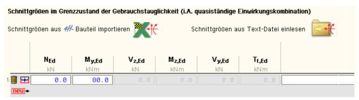
Der Rissnachweis wird im Grenzzustand der Gebrauchtauglichkeit geführt. Die Bemessungsgrößen können manuell eingegeben, aus einem pcae-Programm importiert oder aus einer Text-Datei eingelesen werden.
