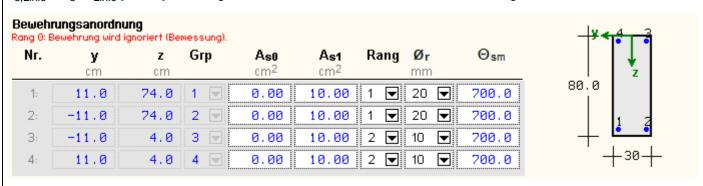
Bezogen auf das angegebene Koordinatensystem (in der Mitte der Querschnittsoberkante) werden die Angaben der Achsabstände in Querschnittskoordinaten umgerechnet und in einer Tabelle aufgeführt.
