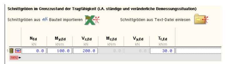
Biege- und Schubbemessung werden im Grenzzustand der Tragfähigkeit geführt. Die Bemessungsgrößen können manuell eingegeben, aus einem pcae-Programm importiert oder aus einer Text-Datei eingelesen werden.
