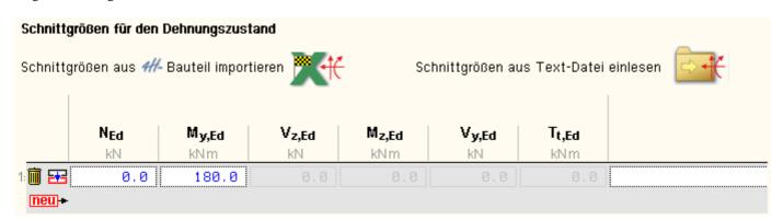
Der Dehnungszustand wird i.A. mit den Schnittgrößen im Grenzzustand der Gebrauchstauglichkeit berechnet.
