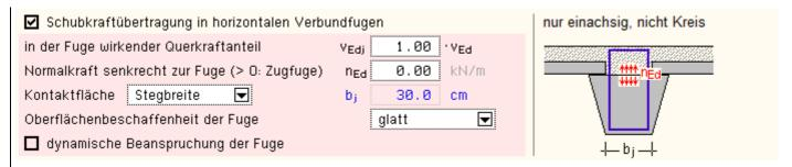
Einachsig beanspruchte Querschnitte (Rechteck, Platte, Plattenbalken, Überzug, nicht Kreis) können als Verbundbauteile (z.B. Elementdecken, Unter-, Überzüge) hergestellt werden.
