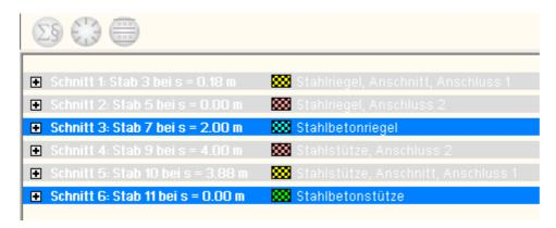
In der Schnittgrößenauswahl werden die verfügbaren Schnittgrößenkombinationen aller im übergebenden Programm gekennzeichneten Schnitte angeboten. Dabei sind diejenigen Schnitte deaktiviert, deren Material mit dem Detailprogramm nicht kompatibel ist.
