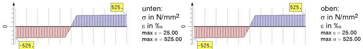
Spannungsdehnungslinie des Betons: EC 2-1-1, 3.1.5 (wirklichkeitsnah)
