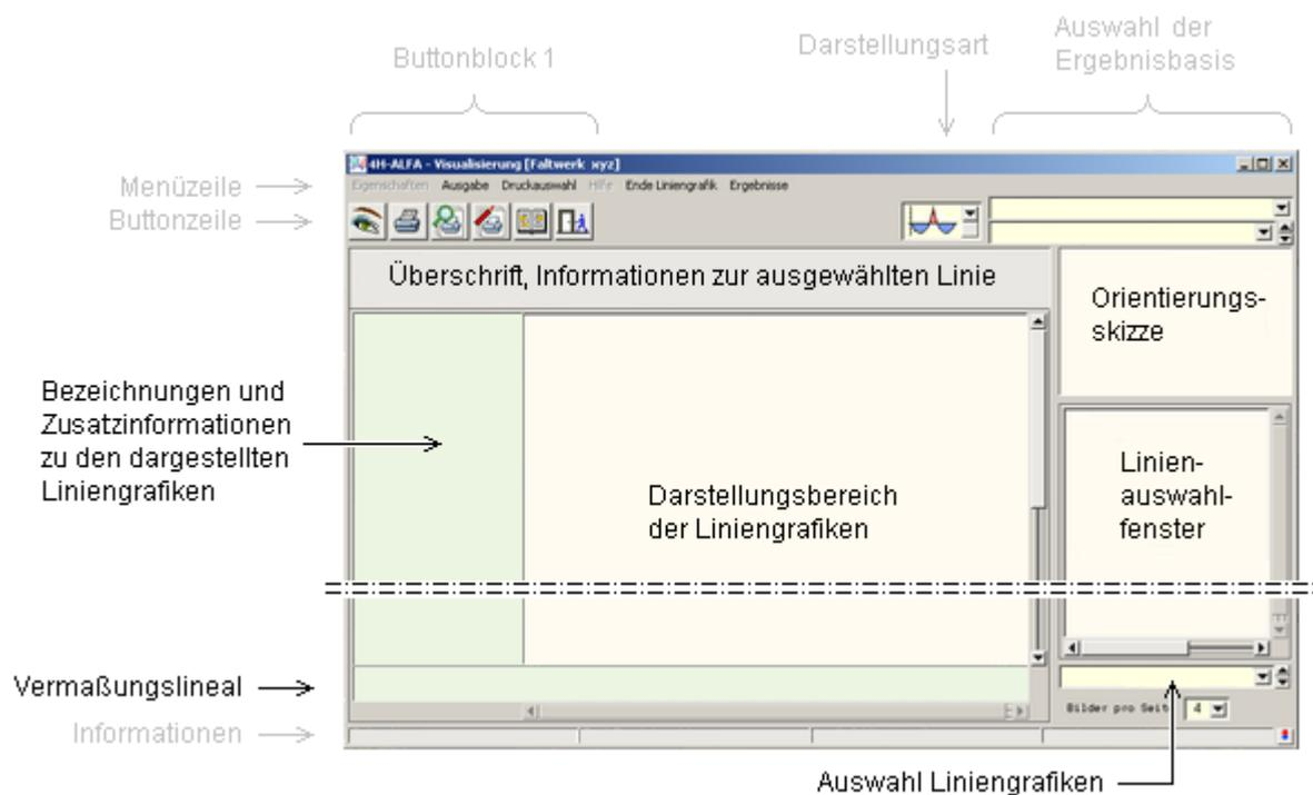
Im *Linienauswahlfenster* werden die definierten Schalen in einer Baumstruktur zur Auswahl angeboten.
