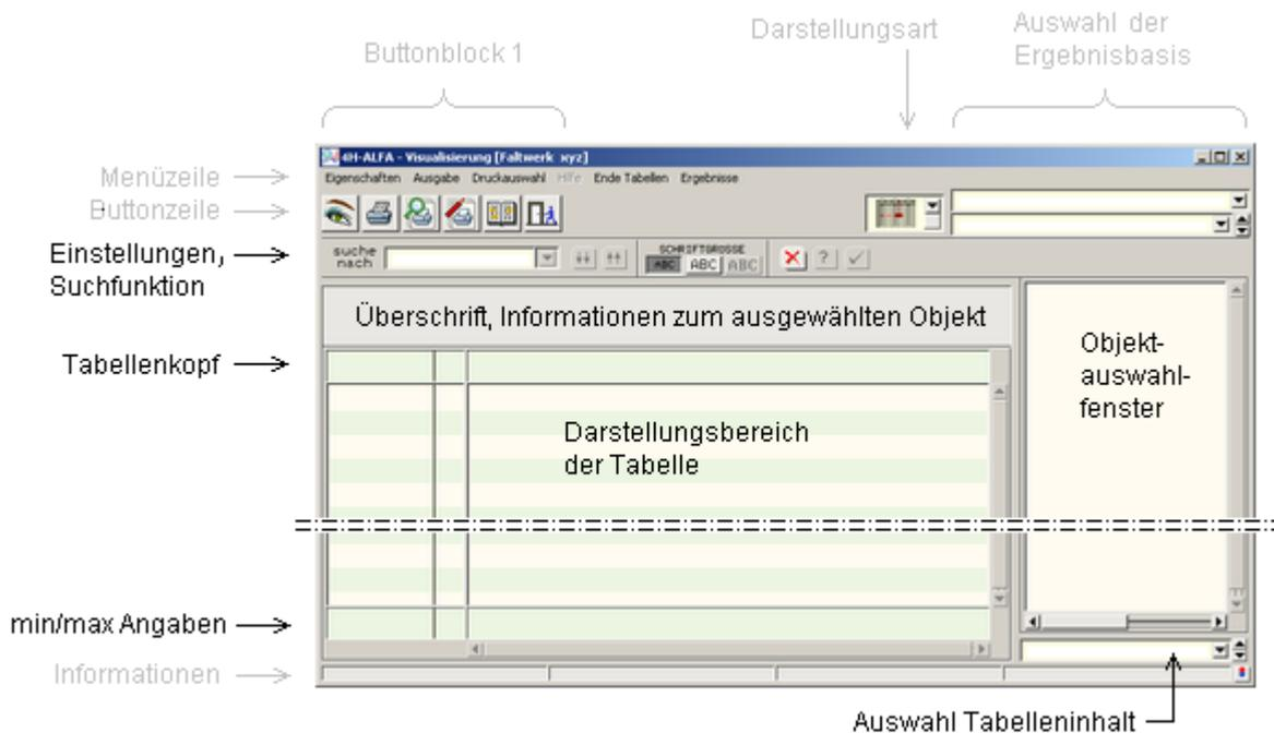
Im *Objektauswahlfenster* werden alle Objekte (Flächenpositionen, Stäbe, Linienlager sowie Punkte und definierte Schnitte) zur Auswahl angeboten.
